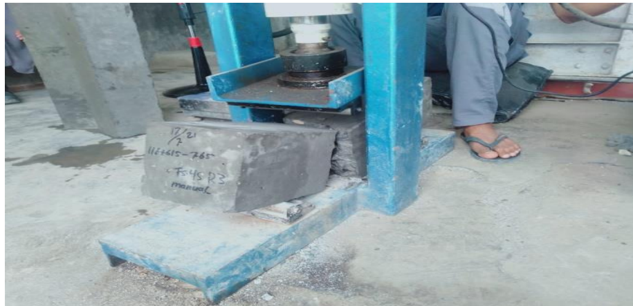
Gambar 3.17. Pengujian kuat lentur beton
