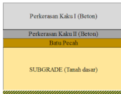
Gambar 3.5. Struktur perkerasan kaku
