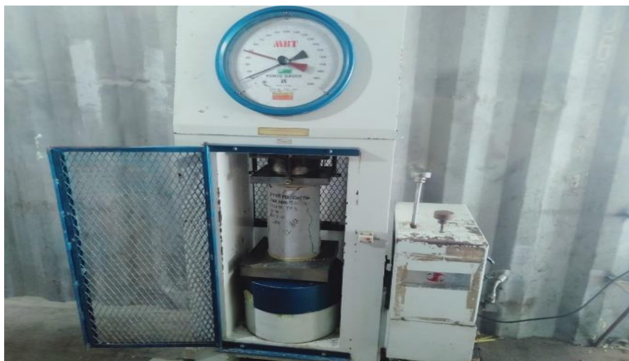
Gambar 3.16. Pengujian kuat tekan beton
