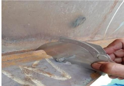
Gambar 2. 16 Mengukur tinggi *capping*.
