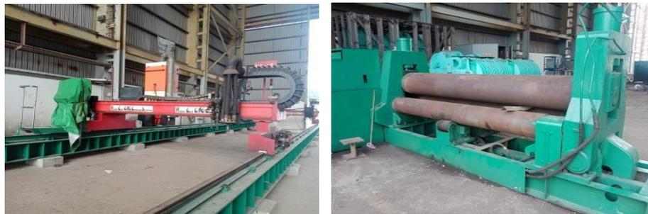
Gambar 2. 12 Pengenalan Mesin Potong dan Roll
