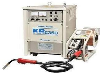
Gambar 3. 7 Mesin Las Fcaw
