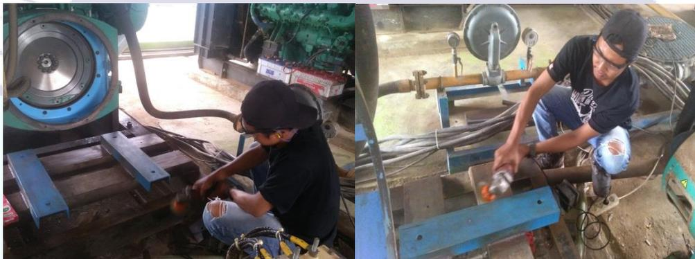
Gambar 2.12 Membuat tapak generator pada engine
