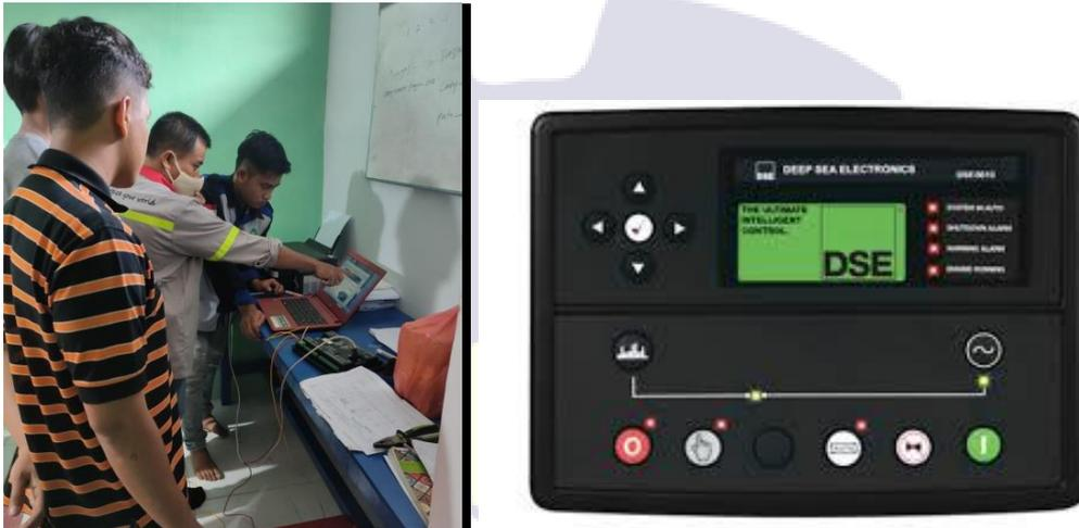
Gambar 2.16 Pemrograman modul APK Deep Sea electronics sebagai monitoring sumber : (Dokumentasi Penulis 2020)
