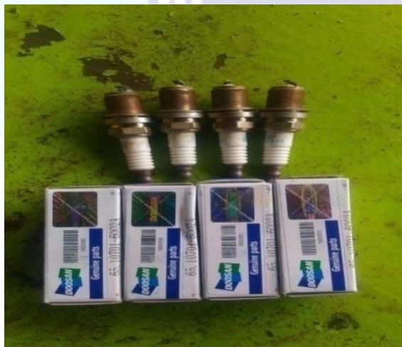
Gambar 2.10 Pengecekan dan pergantian busi (*Spark plug*) pada *engine* D#2
