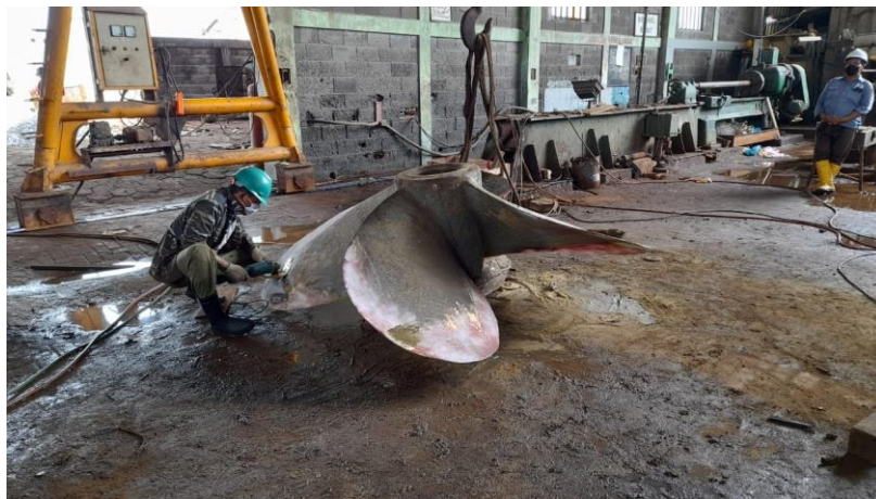
Gambar.3.14. Penggerindaan Daun Propeller
