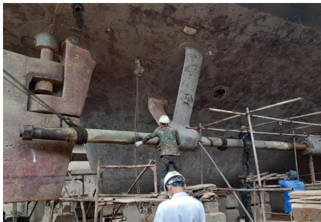
Gambar 2.18 Pelepasan Shaft Bagian Kanan Kapal Kirana III
