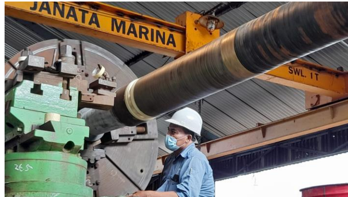
Gambar 2.27 Perbaikan Shaft Propeller MT Triaksa
