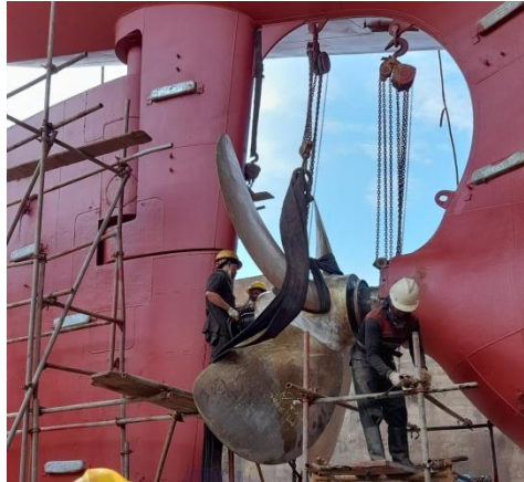
Gambar 2.37 Proses Pemasangan Propeller Kapal MT. Sinar Masela
