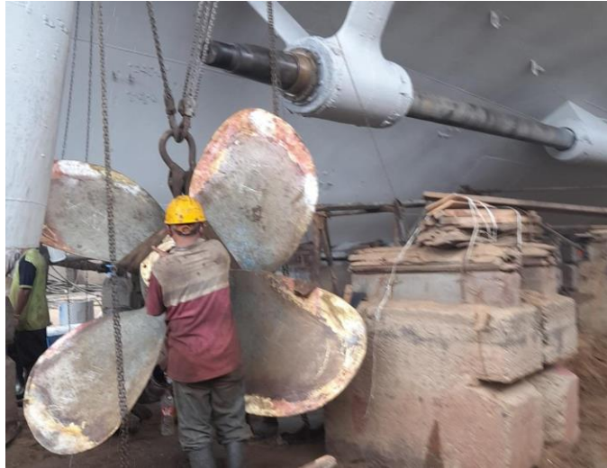
Gambar 2.22 Pemasangan Propeller KM Kirana III
