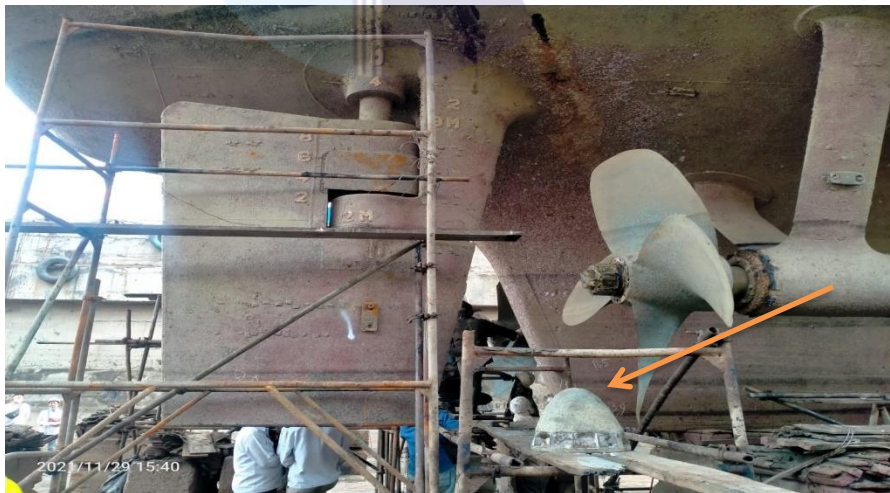
Gambar 3.3. Proses pelepasan Hub Cap
