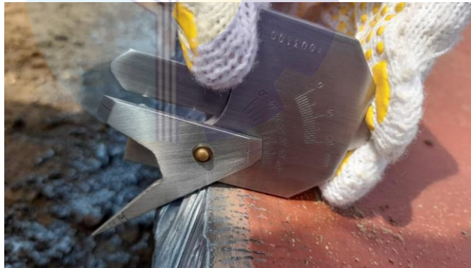
Gambar 2.36 Proses Pengukuran Sudut Kemiringan Bevel
