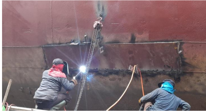
Gambar 2.8 Fit Up Plat Baru
