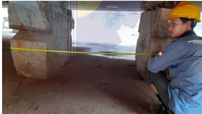
Gambar 2.34 Pengukuran jarak antar Stop Block
