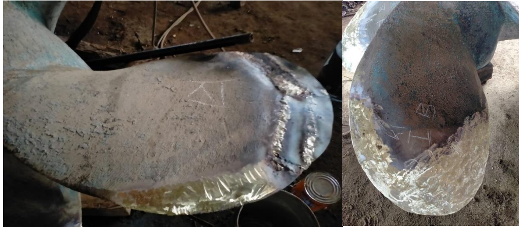
Gambar 3.9. Proses pengerindaan daun propeller
