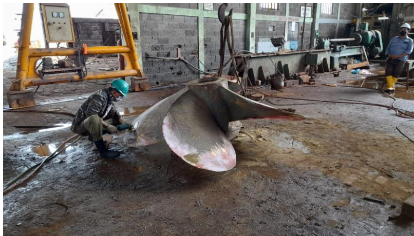
Gambar.3.14. Penggerindaan Daun Propeller
