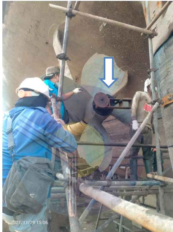
Gambar 3.5. Proses pelepasan shaft propeller
