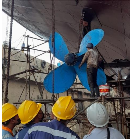
Gambar 2.3 Pemasangan Propeller KMP Kumala
