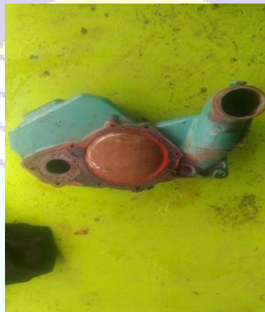
Gambar 2.11 Pergantian sperpak water pump pada engine D#4 .
