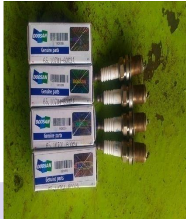
Gambar 2.13 Pengecekan dan pergantian busi ( Spark plug ) pada engine D# 4
