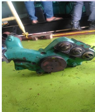
Gambar 2.15 Pergantian Coolant Pump pada engine D#3.
