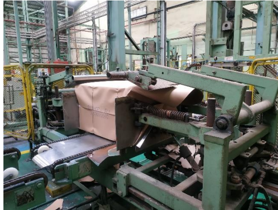
Gambar 3.6 Folding Machine melipat sisi bawah
