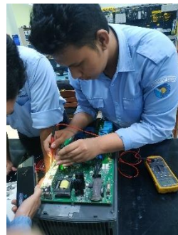
Gambar 2.14 Bongkar dan Perbaikan VSD ACS-800
