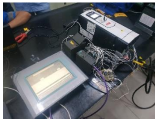
Gambar 2.9 Mengkoneksikan PLC ke VSD dikontrol dengan HMI
