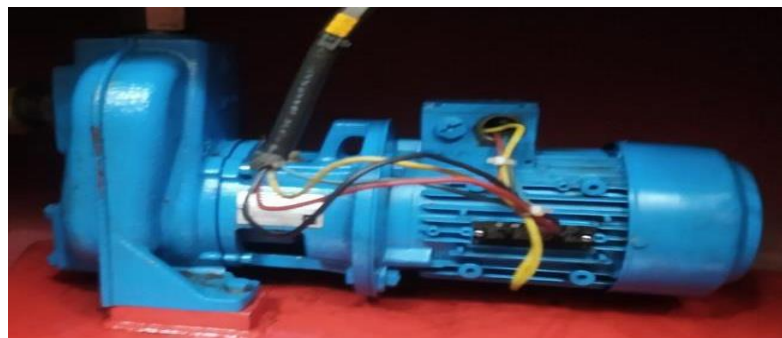
Gambar 3. 8 Motor listrik AC (Sumber: Unit Layanan PLTA Koto Panjang. 2022)
