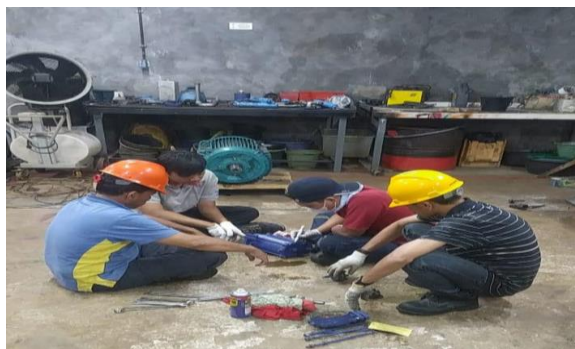
Gambar 2. 11 Maintenance pada pompa shaft seal (Sumber: Unit Layanan PLTA Koto Panjang. 2022)
