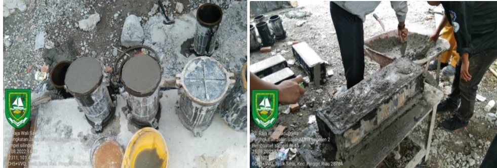
Gambar 3. 30 Pembuatan sampel beton fs 45
