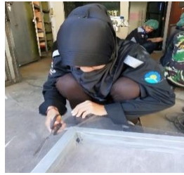
Gambar 2. 29: pemotongan flexilon Sumber : Dokumentasi pribadi di PT.Cassia Co-op.
