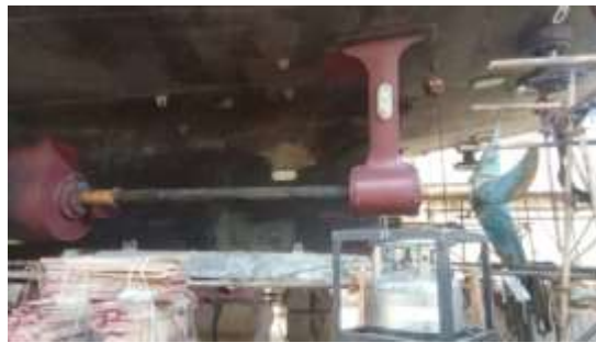
Gambar 2.43 Pemasangan Shaft Propeller
