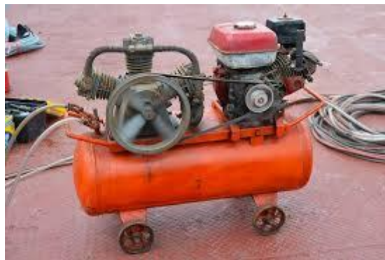
Gambar 3.1 Compressor (Sumber : Dokumentasi Lapangan, 2021)
