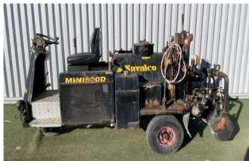
Gambar 3.3 Asphalt sprayer (Sumber : Dokumentasi Lapangan,2021)
