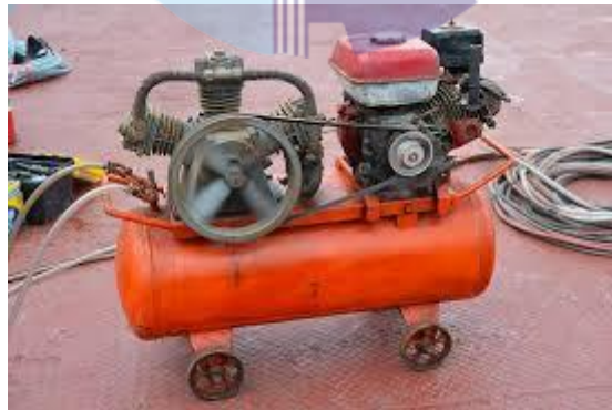
Gambar 3.1 Compressor (Sumber : Dokumentasi Lapangan, 2021)
