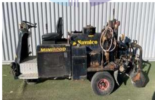
Gambar 3.3 Asphalt sprayer (Sumber : Dokumentasi Lapangan,2021)
