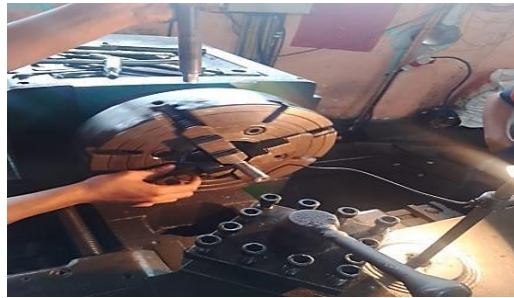
Gambar 4.6 Setting Benda Kerja Sumber : Dokumentasi
