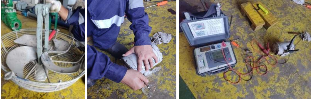
Gambar 2.7 Megger Motor 3 Phase
