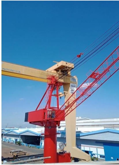
Gambar 1. 7 Crane Goliath 300 Ton
