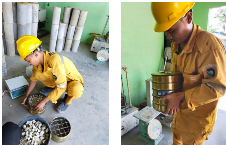
Gambar 3. 3 Analisa saringan Agregat Kasar Sumber : Dokumentasi 2022
