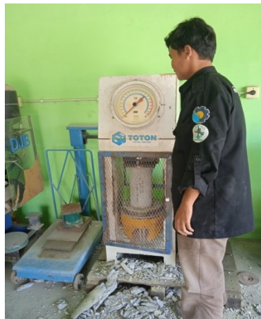
Gambar 3. 7 Pengujian kuat tekan sampel beton
