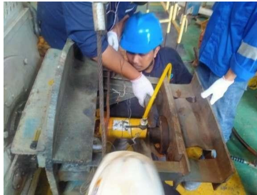
Gambar 2.44. Penanggalan Kopling Pada Motor HPFF6 Kv (Sumber: Dokumentasi di PT PJB UBJOM PLTU Tenayan)
