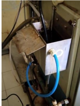
Gambar 2.5 Pemlasingan Air Sample Line (Sumber: Dokumentasi PT. Indah Kiat Pulp & Paper Tbk Perawang, 2022)
