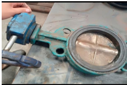
Gambar 4.9 Membuka Baut yang Mengikat Stem ke Valve
