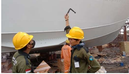
Gambar 2.56 Mengukur titik embun dan kelembapan udara
