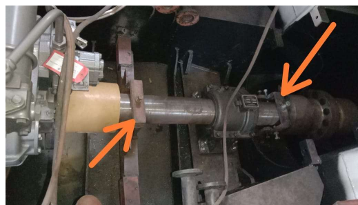
Gambar 2.36 Pemasangan Support pada Shaft Propeller
