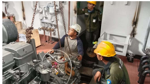
Gambar 2.31 Proses penyatuan Main Engine dan Gear Box
