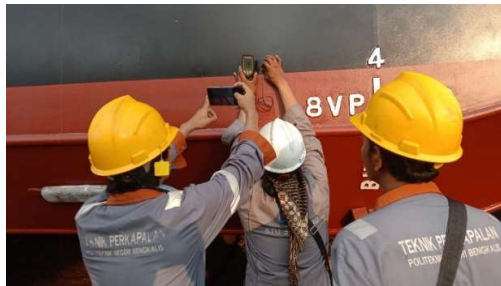
Gambar 2.49 Pengetesan ketebalan cat pada kapal tongkang
