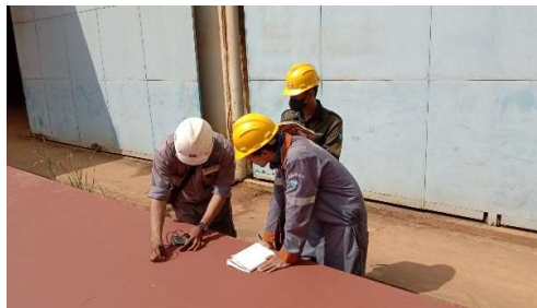
Gambar 2.52 Mengetahui ketebalan cat dengan alat DFT
