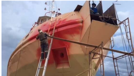
Gambar 2.47 Prosedur reparasi permukaan dan pengecatan pada baja
