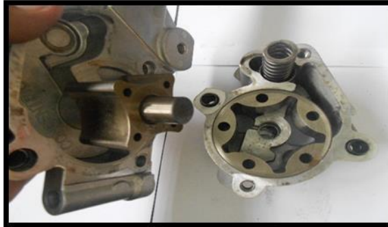
Gambar 4. 23 Outer rotor dan inner rotor Sumber: PT. Besmindo Materi Sewatama
