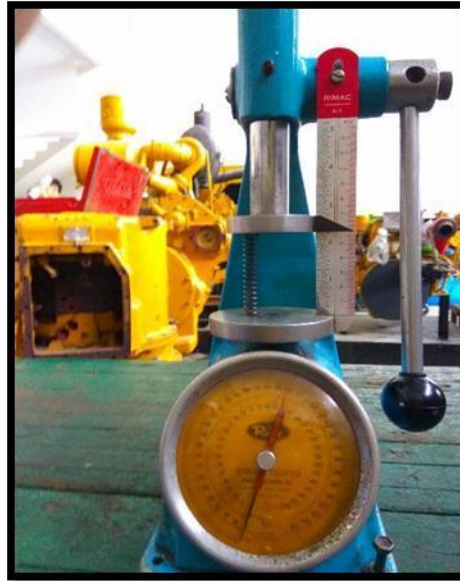
Gambar 4. 25 Pengukuran spring pada bypass valve Sumber: PT. Besmindo Materi Sewatama
