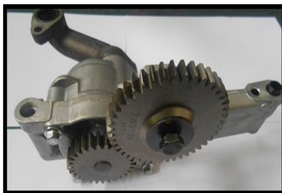
Gambar 4. 12 Bolt pada idler gear Sumber: PT. Besmindo Materi Sewatama
