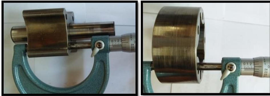
Gambar 4. 18 pengukuran length Sumber: PT. Besmindo Materi Sewatama
