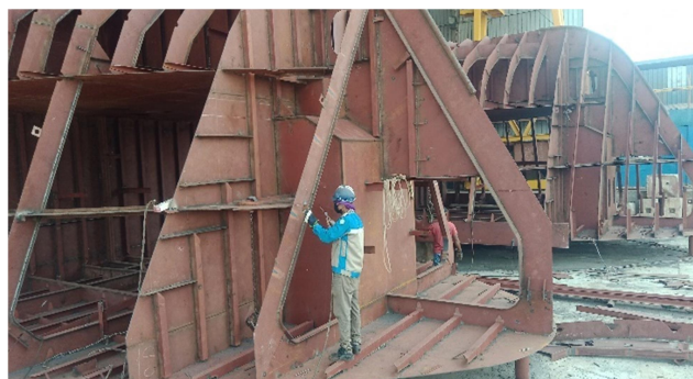
Gambar 2.22 : Proses tahapan pembuatan awal Haluan tugboat
