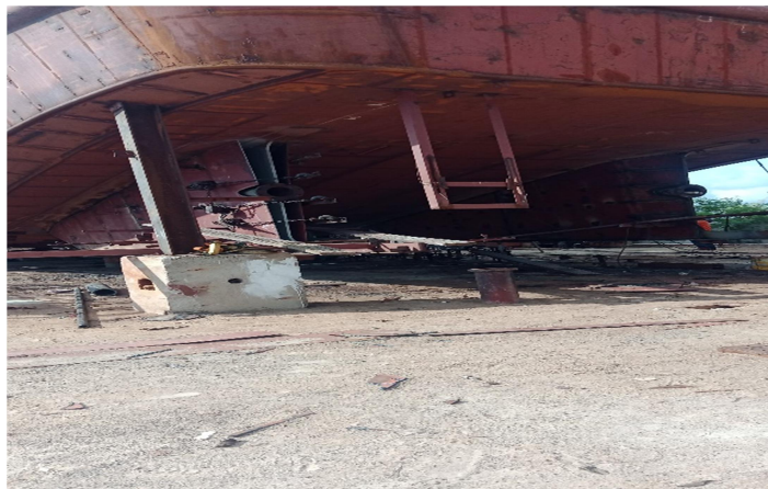
Gambar 2.34 ; Proses pembuatan kedudukan propeller
