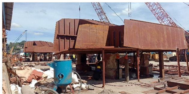
Gambar 2.21 ; Proses tahapan pembuatan awal buritan tugboat
