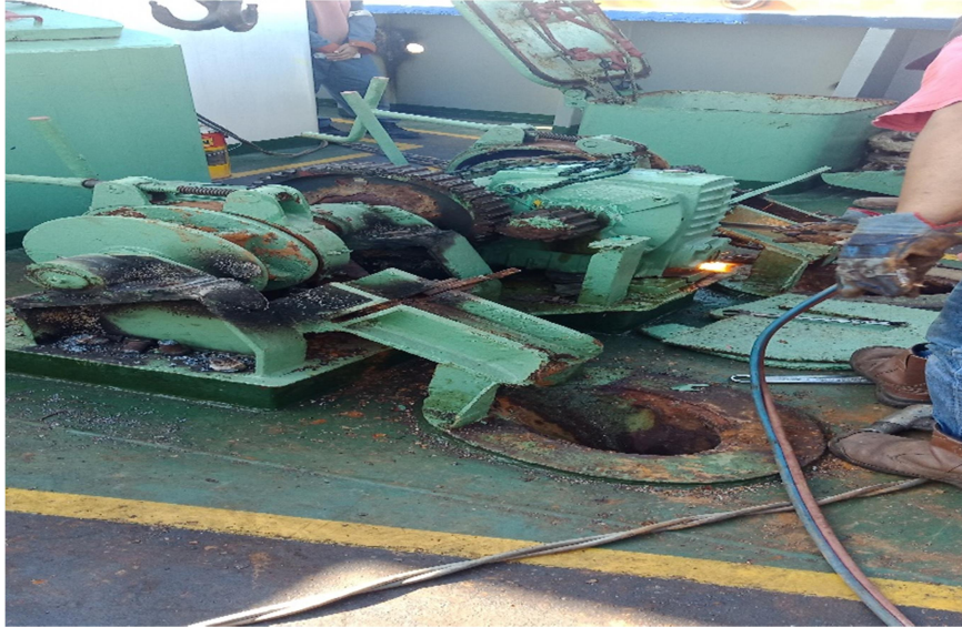
Gambar 2.14 : proses membukak baut pada mesin jangkar/ anchor machine
