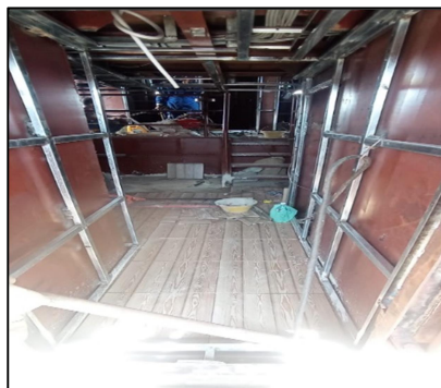
Gambar 2.37 : proses pembuatan lajur geladak pada kapal
