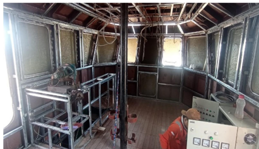
Gambar 2.35 : Proses pembuatan bagian dalam anjungan/bridge pada kapal baru tugboat
