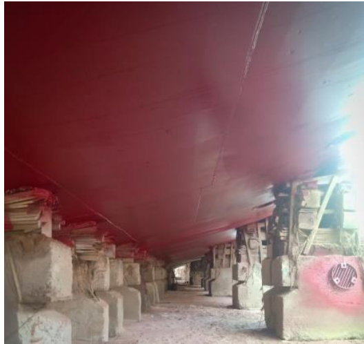
Gambar 3.14 Keel block dan side block
