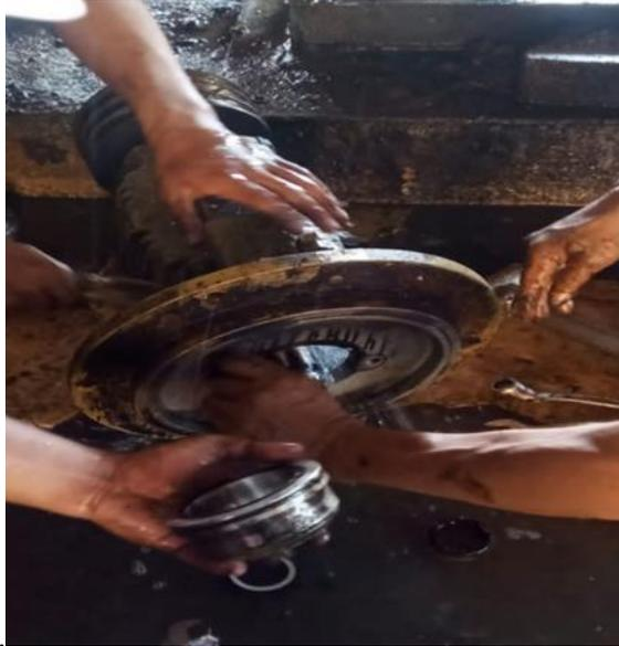
*Gambar 4.10. 3. Proses Pemasangan Mechanical Seal pompa kewpump KS-SE2
