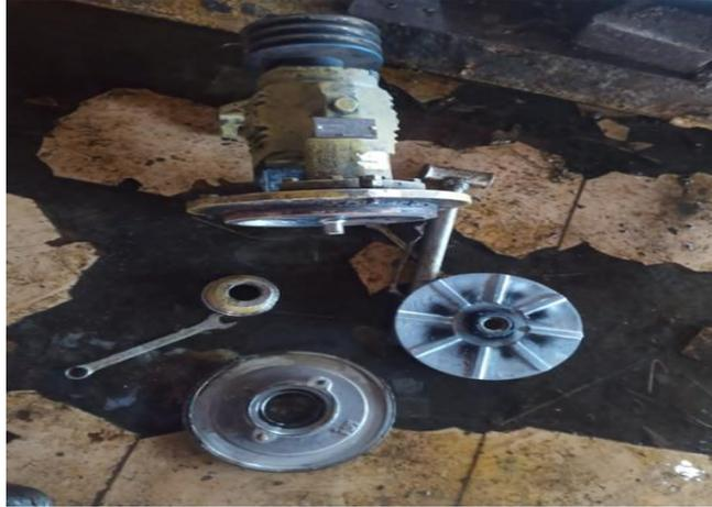
*Gambar 4.10. 1.bagian-bagian pompa kewpump ks-se2
