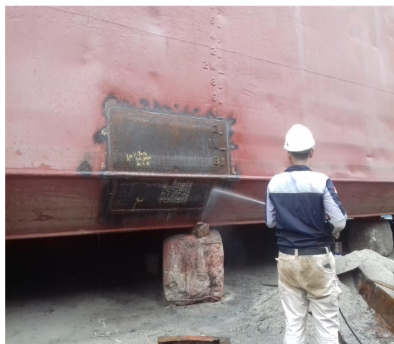
Gambar 3.5. Proses penyemprotan air sabun
