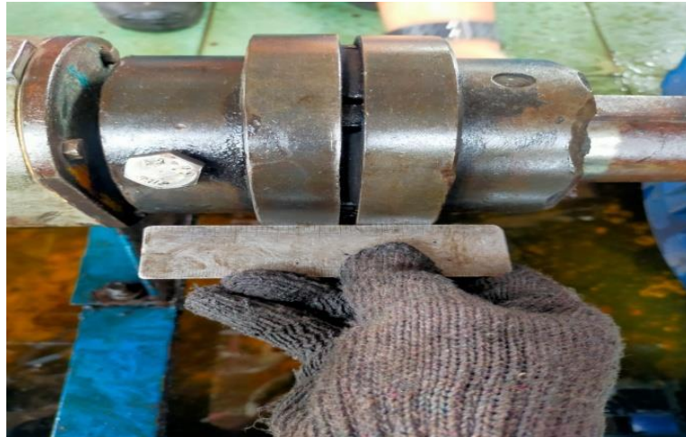
Gambar 4. 15 Proses penyetelan coupling (Sumber : PT. Wilmar Nabati Indonesia)
