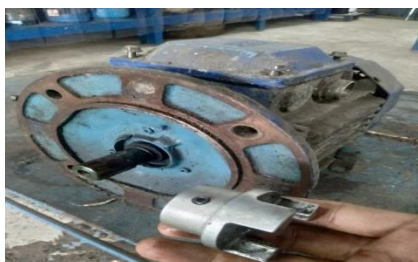
Gambar 2. 26 Membuka Kopling Motoran Menggunakan Treker
