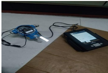
Gambar 2. 9 Pengecekan Pressure Transmitter Menggunakan Hart (Sumber: PT. WINA OLEO CHEMICAL, 2022)
