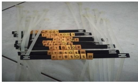
Gambar 2. 11 Pembuatan Tagging Kabel (Sumber: PT. WINA OLEO CHEMICAL, 2022)
