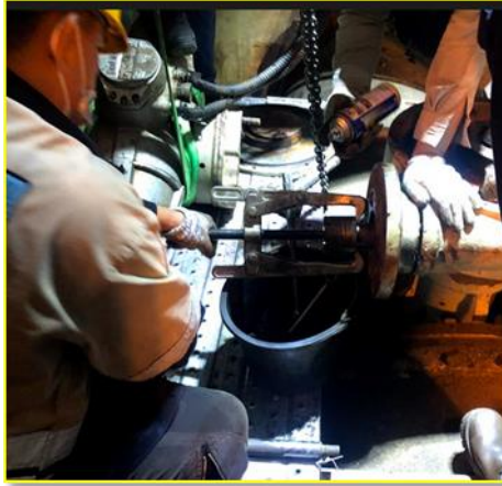
Gambar 4.16 Lepas coupling poros gearbox Sumber: Dokumentasi Pribadi
