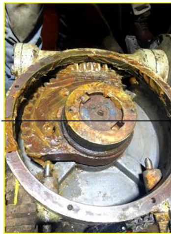
Gambar 4. 23 Beri grease pada gearbox Sumber: Sumber: Dokumentasi Pribadi
