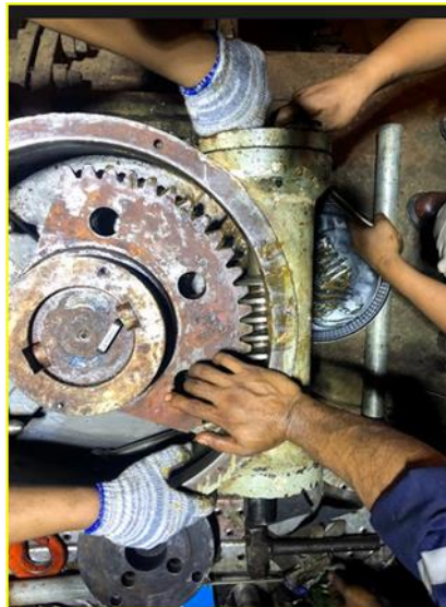
Gambar 4. 15 Lepas cover bearing sisi NDE Sumber: Dokumentasi Pribadi
