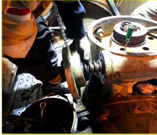
Gambar 4.18 Lepas poros dan worm gear pada gearbox Sumber: Dokumentasi Pribadi
