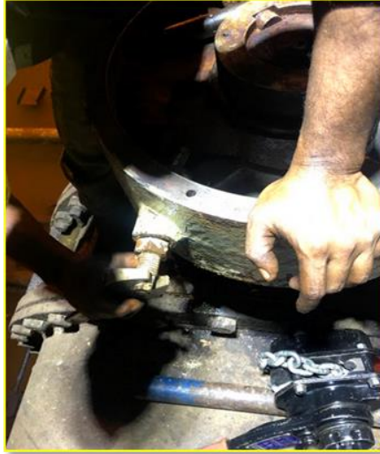
Gambar 4. 22 Pasang kembali coupling poros Sumber: Dokumentasi Pribadi
