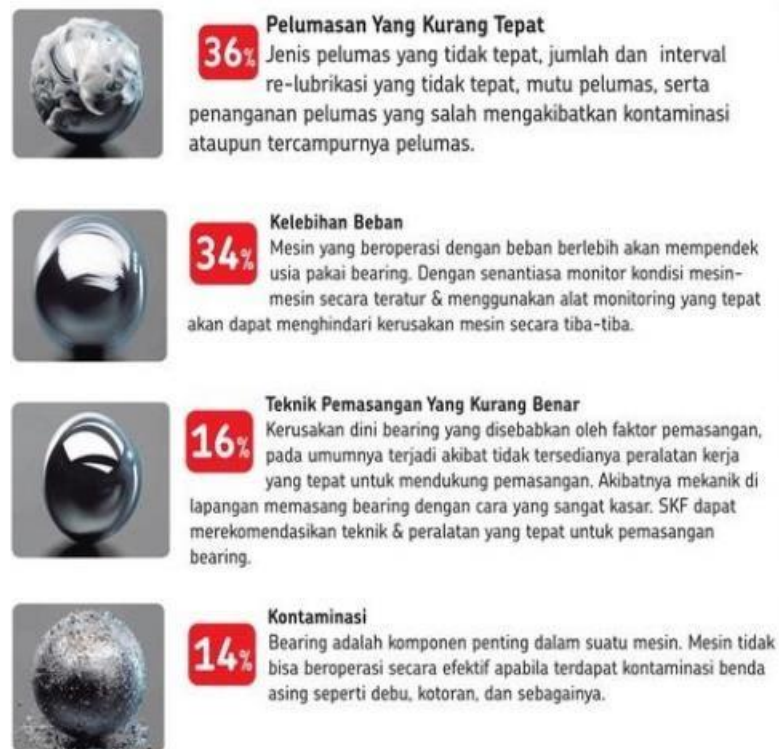
Gambar 4.9 Penyebab terjadinya kerusakan bearing Sumber: https://www.kogelaha.com/tahukah-anda-penyebab-kerusakan-bearing/
