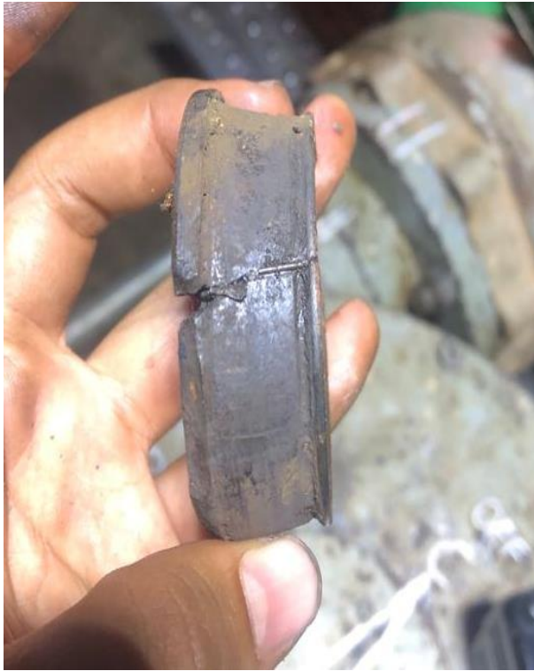
Gambar 4. 12 Penyebab bearing harus diganti Sumber: Dokumentasi Pribadi
