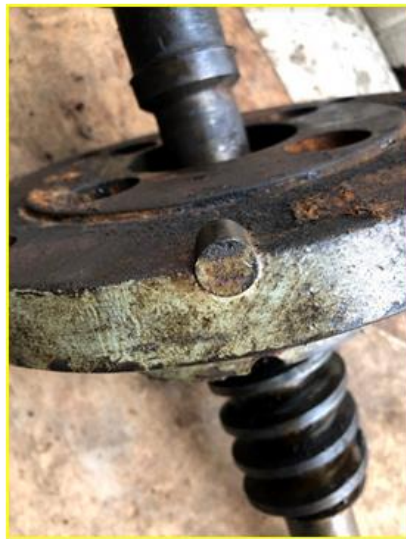
Gambar 4. 21 Pasang kembali poros serta warm gear Sumber: Dokumentasi Pribadi
