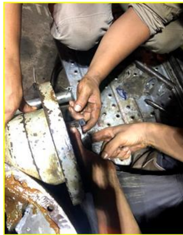
Gambar 4. 17 Lepas cover bearing sisi DE Sumber: Dokumentasi Pribadi
