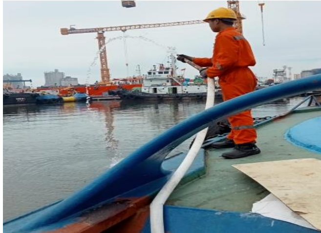
Gambar 2.16 Pengetesan pada Nozel Hydrant Kapal
