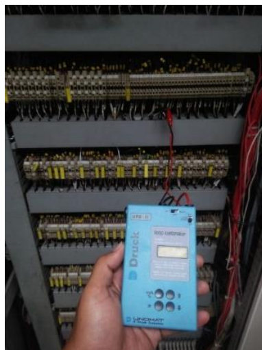
Gambar 2.6 simulasi AI dan AO chanel menggunakan Loop Calibrator (Sumber : Dokumentasi PT. Indah Kiat pulp & paper Tbk Perawang, 2022)
