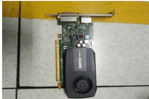
Gambar 2.18 bentuk fisik dari VGA (Sumber : Dokumentasi PT. Indah Kiat pulp & paper Tbk Perawang, 2022)
