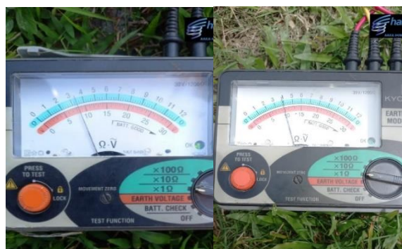
Gambar 2.16. pengukuran tegangan grounding
