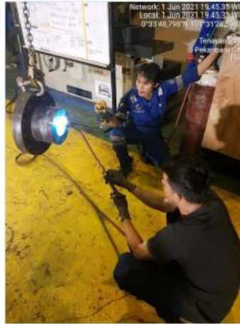
Gambar 4. 57 Pemanasan coupling fan
