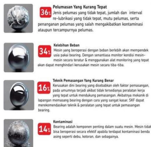
Gambar 4. 7 Penyebab Terjadinya Kerusakan Bearing
