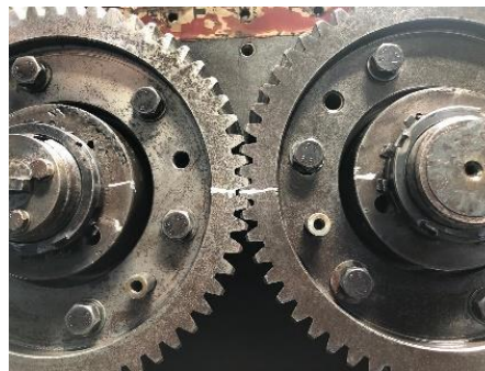
Gambar 4. 27 Marker komponen sisi NDE
