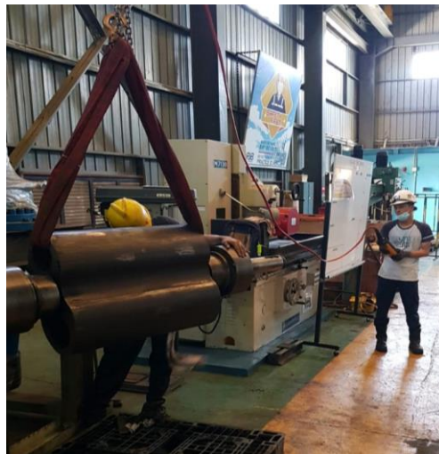
Gambar 4. 40 Pemasangan lobe drive
