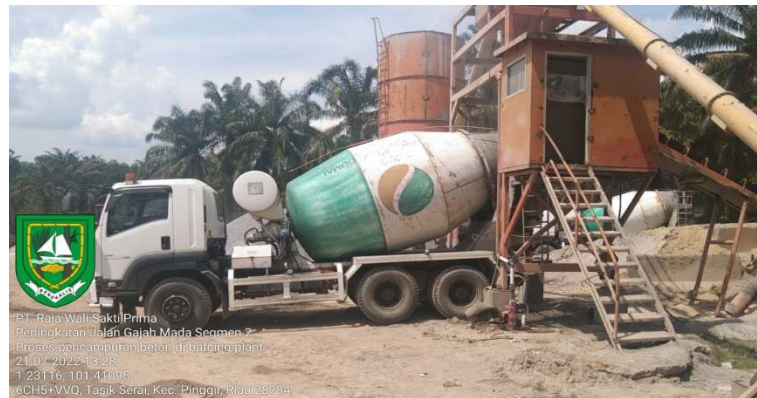
Gambar 3.9 Truck Mixer Sumber : Dokumentasi lapangan, 2022
