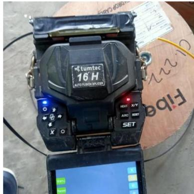
Gambar 4.5 Pemanasan Protec Agar Protec Terlapisi dengan Protec
