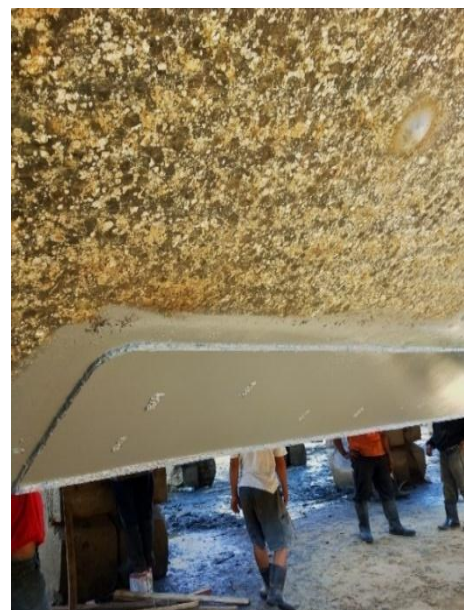
Gambar 2.6 pengecatan plat yang di ganti
