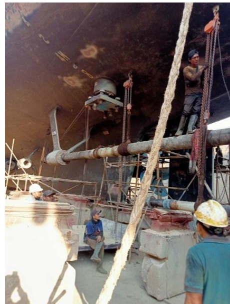
Gambar 2.30 proses pelepasan shaft
