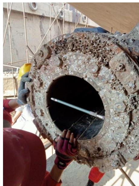
Gambar 2.22 pengukuran bantalan shaft
