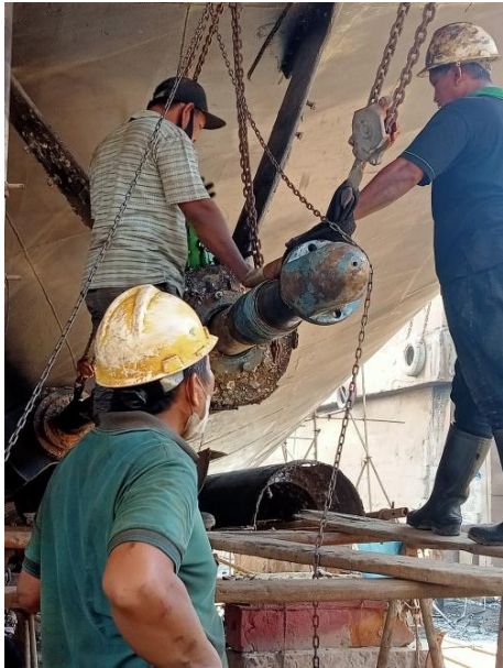
Gambar 2.27 perbaikan shaft propeller
