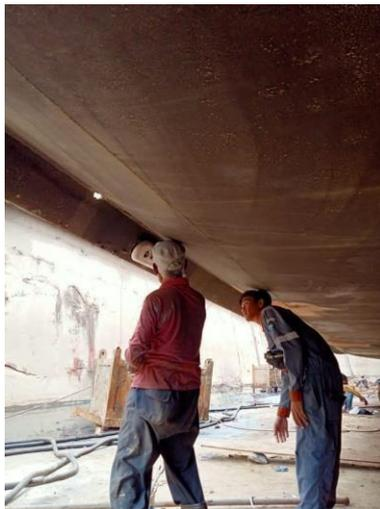
Gambar 2.13 pemasangan zinc anoda
