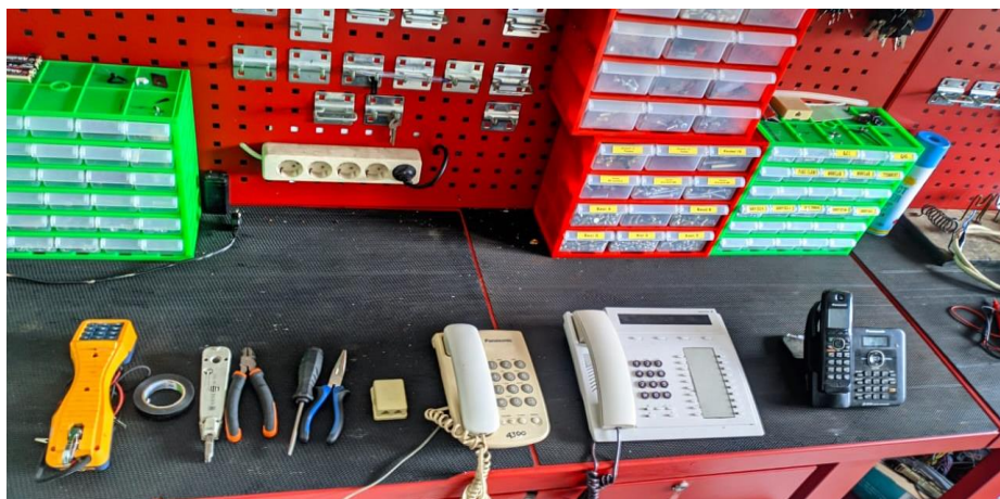
Gambar 3.3 Jenis telephone serta alat yang digunakan untuk installasi kabel telephon
