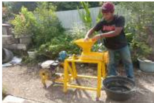
Gambar 4.14 proses penggilingan pelet ikan
