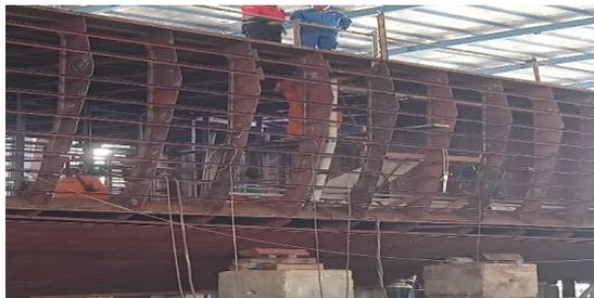
**Gambar 2.70** Kontruksi kapal *hull*
