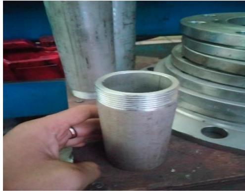
**Gambar 2.13** Pipa Sambungan ke Pompa
