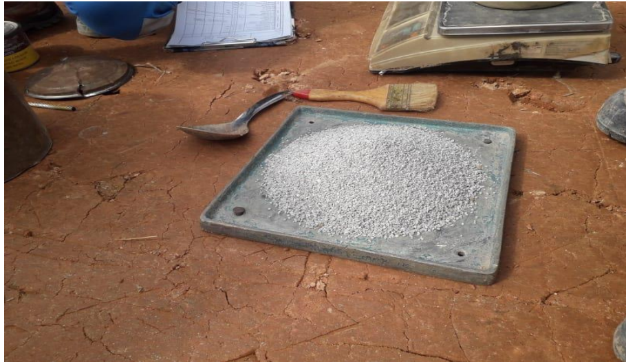
Gambar 3.8. Pengujian sandcone (Sumber : Dokumentasi Lapangan,2022)
