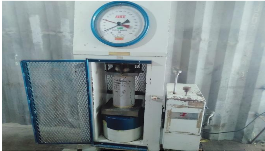
Gambar 3.15. Pengujian kuat tekan beton (Sumber : Dokumentasi Lapangan,2022)
