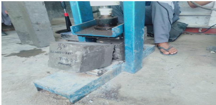
Gambar 3.16. Pengujian kuat lentur beton (Sumber : Dokumentasi Lapangan,2022)
