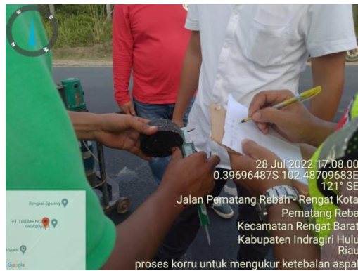
Gambar 4.24 Pengukuran Sampel Laston Lapis Aus (AC-WC) (Sumber: Dokumentasi Lapangan Kerja Praktek 2022)
