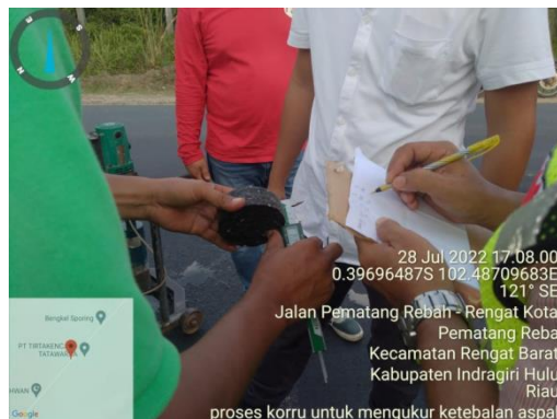
Gambar 3.12 Pengukuran Sampel Laston Lapis Aus (AC-WC) (Sumber: Dokumentasi Lapangan Kerja Praktek 2022)
