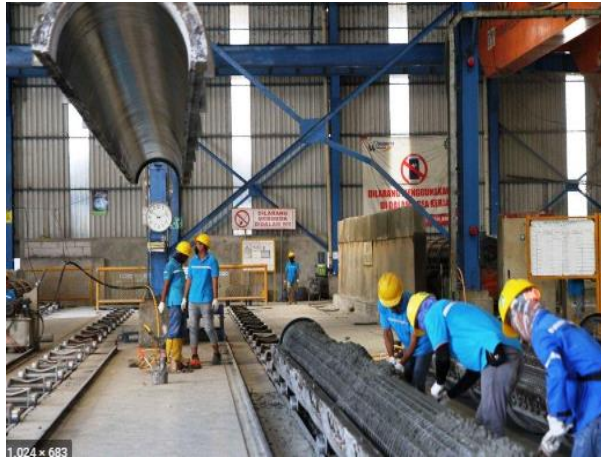
Gambar 3. 21 Pemasangan tutup cetakan
