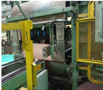
Gambar 3. 5 Pulp masuk ke dalam mesin bywrap
