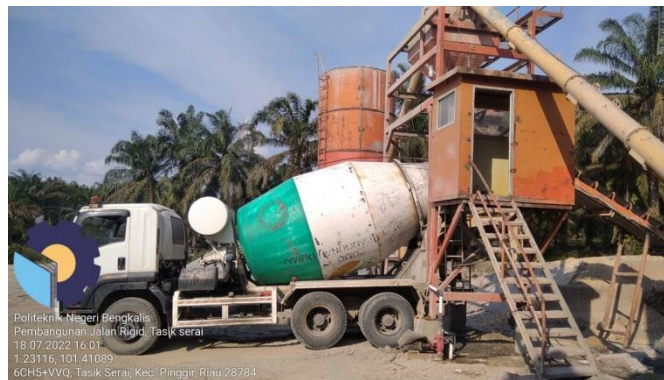
Gambar 3.10 Produksi Lc Di Batching Plant
