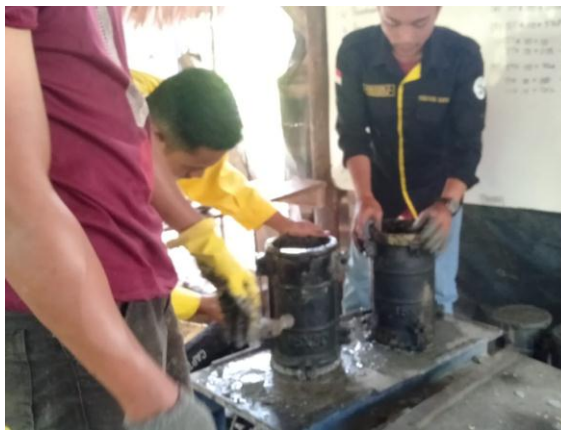
Gambar 4.8 Pengambilan sampel silinder (Sumber . Dokumentasi dilapangan)
