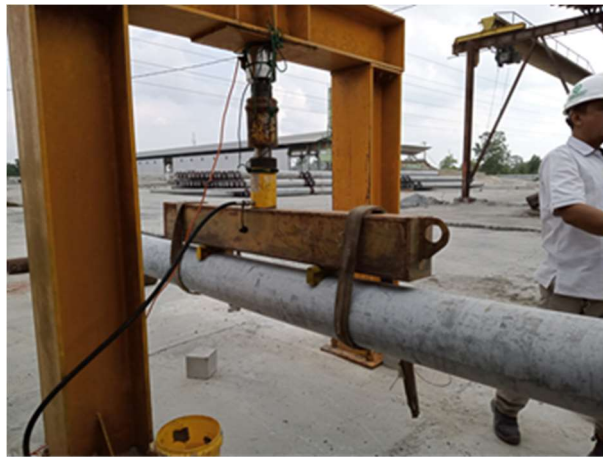
Gambar 3. 20 Bagian Tengah Bentang di Pasang LVDT Sumber: Dokumentasi KP, 2022
