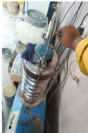
Gambar 3. 9 Pengujian Analisa Saringan Sumber : Dokumentasi KP, 2022
