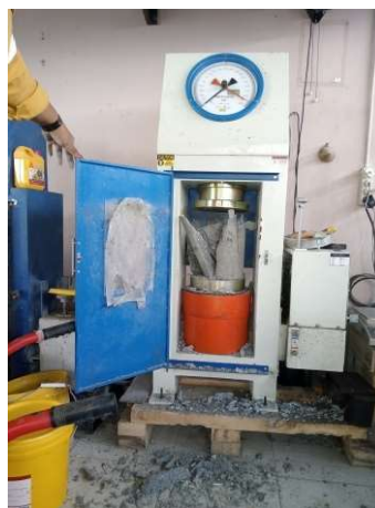
Gambar 3. 22 Pengujian Kuat Tekan
