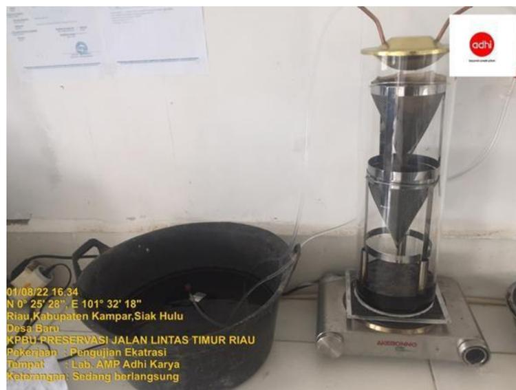
Gambar 3. 16 Pengujian Ekstraksi
