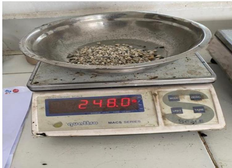
Gambar 3. 15 Pekerjaan Gradasi Agregat
