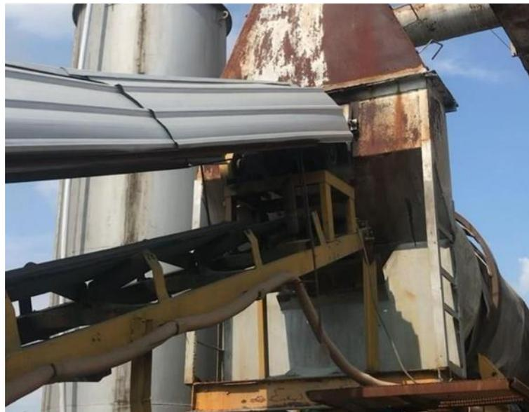
**Gambar 4. 11 Tumpahan Agregat Dingin ke Dalam Dryer**
