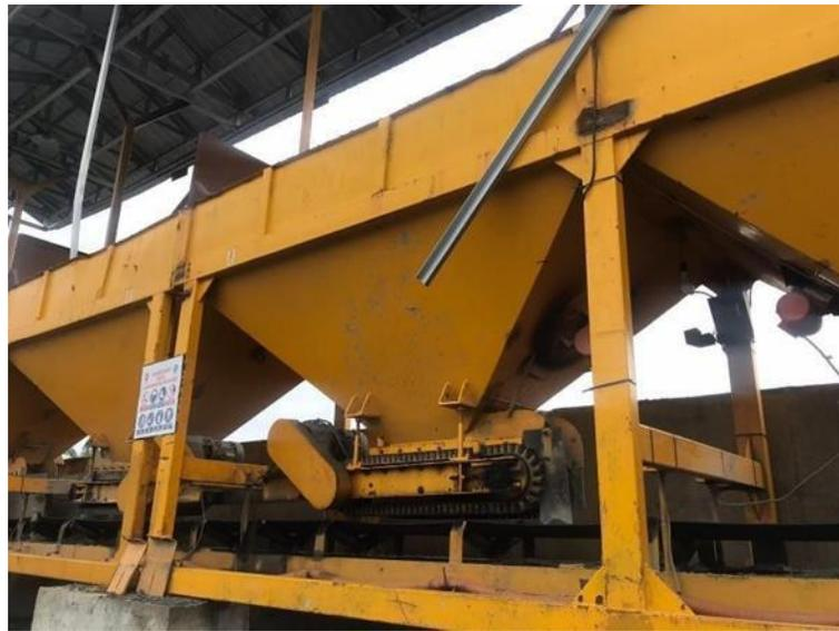
**Gambar 4. 9 Pintu Pengeluaran Agregat (Cold Feed Gate)**
