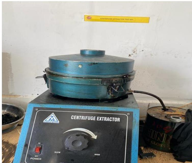
**Gambar 3. 20 Pengujian Kadar Aspal**
