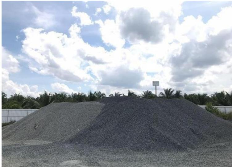
**Gambar 4. 6 Bahan Baku Agregat Untuk Aspal AC-WC**
