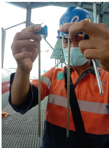
Gambar 2.6 Temperatur transmitter (sumber: dokumentasi penulis 2022)
