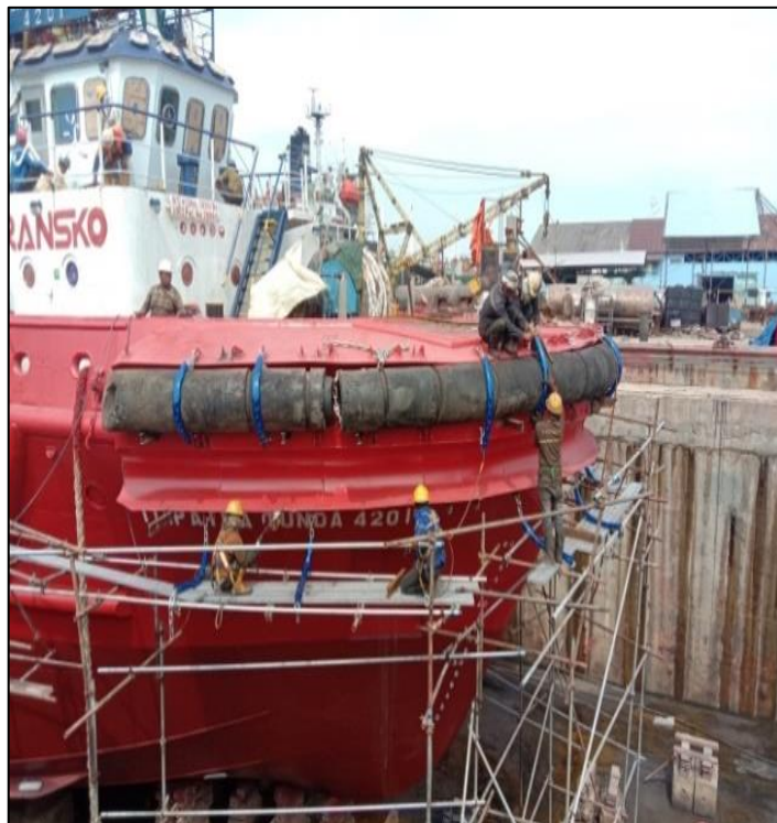
Gambar 2.36 Proses pemasangan rantai untuk Rubber Feeder Sumber : Dokumentasi penulis
