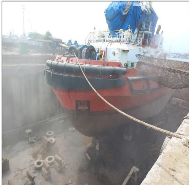
Gambar 2.100 Proses Sanblasting Sumber : Dokumentasi penulis
