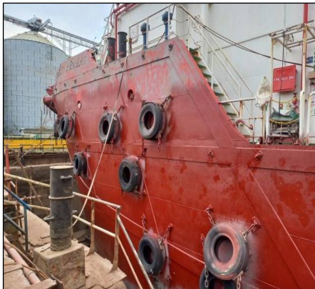
Gambar 2.124 Proses pengecatan (primer) Sumber : Dokumentasi penulis
