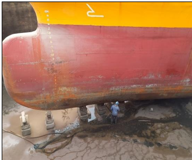
Gambar 2.81 Proses pembersihan lambung kapal Sinar Maluku Sumber : Dokumentasi penulis
