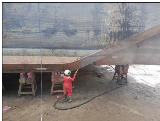
Gambar 2.78 Proses Sanblasting Tongkang Sumber : Dokumentasi penulis
