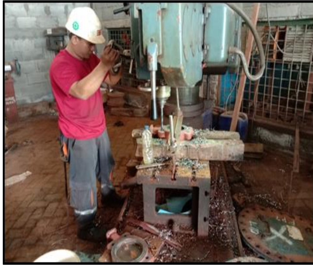
Gambar 2.91 Proses pengeboran lubang baut valve butterfly Sumber : Dokumentasi penulis
