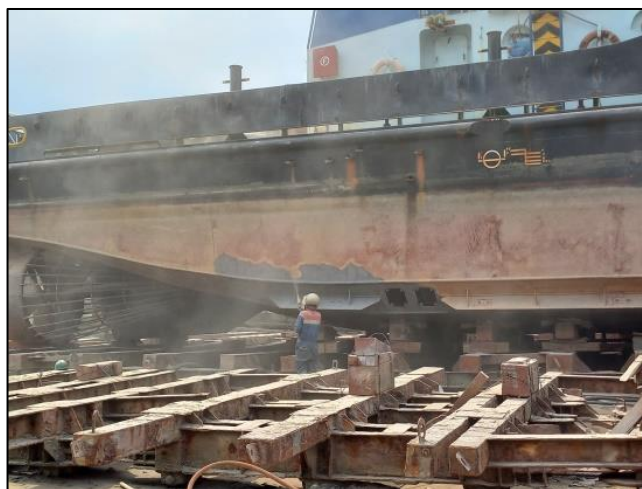
Gambar 2.85 Proses Sandblasting TB.Duta Kapuas 25. Sumber : Dokumentasi penulis
