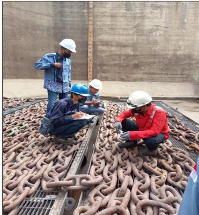
Gambar 2.5 Proses inspeksi rantai jangkar kapal MV. Lintas Mahakam Sumber : Dokumentasi penulis
