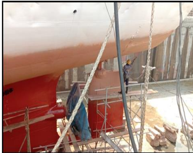
Gambar 2.84 Proses pengecatan Anti fouling Sumber : Dokumentasi penulis
