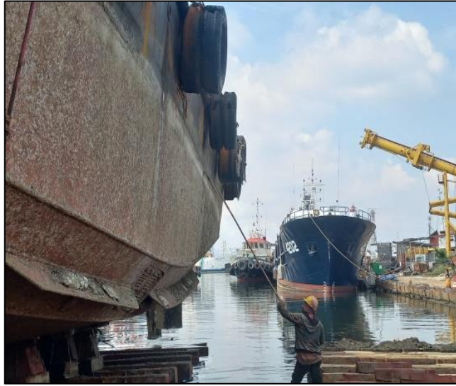
Gambar 2.63 Proses pembersihan lambung kapal TB.Mitra Bahari. Sumber : Dokumentasi penulis
