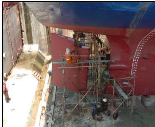
Gambar 2.45 Proses pemasangan daun kemudi Sumber : Dokumentasi penulis
