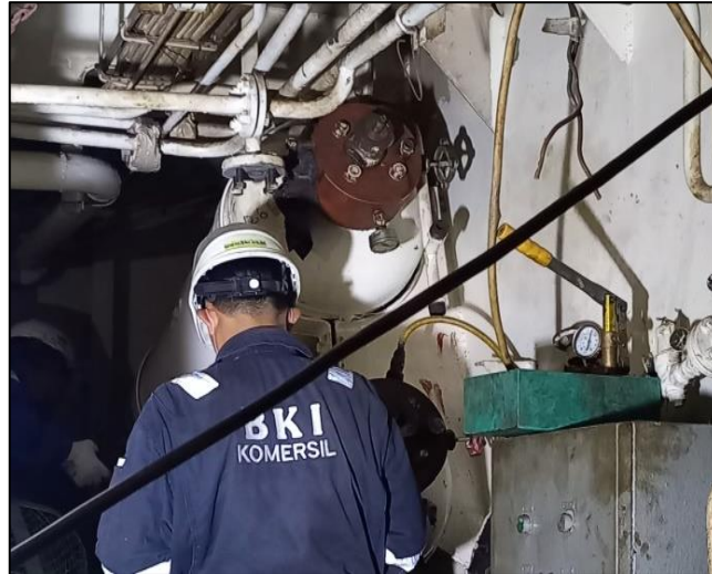
Gambar 2.46 Proses pengujian Press Test botol angin Sumber : Dokumentasi penulis
