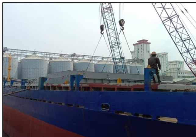
Gambar 2.47 Proses pemasangan tutup palka (Ponton) Sumber : Dokumentasi penulis
