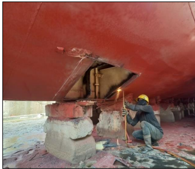
Gambar 2.102 Proses Replating bagian Bottom Sumber : Dokumentasi penulis
