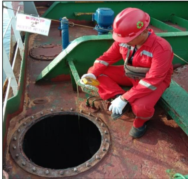
Gambar 2.62 Proses pengecekan Free Gas Test Sumber : Dokumentasi penulis
