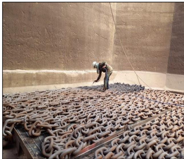
Gambar 2.77 Proses pengecetan Rantai jangkar Sumber : Dokumentasi penulis
