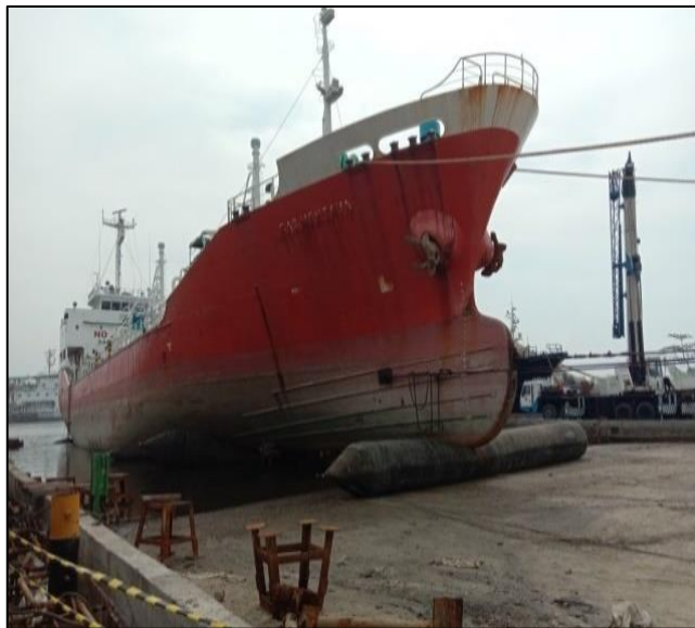
Gambar 2.25 Proses persiapan docking kapal Gas Mentaya Sumber : Dokumentasi penulis
