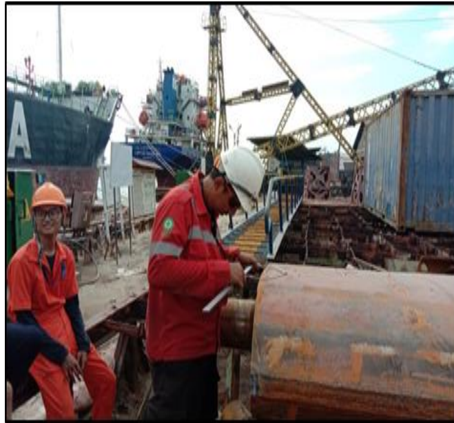
Gambar 2.14 Proses pengukuran diameter pintal kemudi Sumber : Dokumentasi penulis
