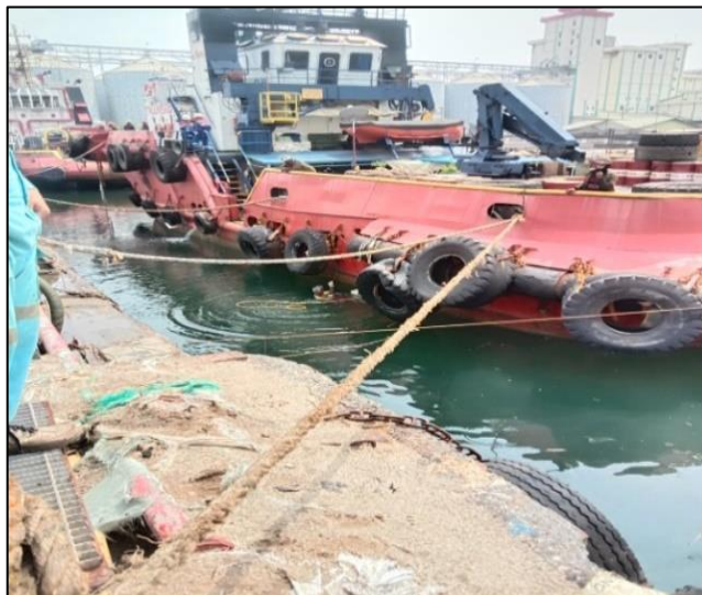
Gambar 2.11 Proses centering kapal terhadap keel block Sumber : Dokumentasi penulis
