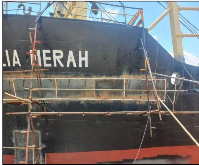
Gambar 2.149 Proses pengujian plat menggunakan kapur solar Sumber : Dokumentasi penulis
