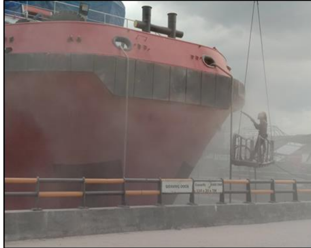
Gambar 2.18 Proses Sand Blasting pada lambung kapal Peteka 5402 Sumber : Dokumentasi penulis
